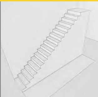
La típica escalera recta conduce al siguiente piso sin descansos intermedios ni escalones triangulares.
